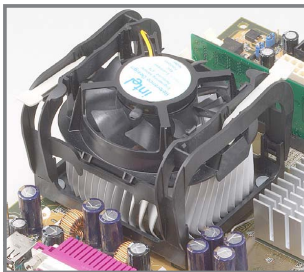
圖示 2-10 風扇和支撐機構的安裝與鎖定
