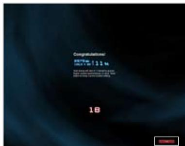
4. 「停止」を選択しなかった場合、TurboVは自動的に更なるシステムオーバークロック設定と安定性のテストを実行し、オーバークロックの経過を示す画面が表示されます。オーバークロック作業をキャンセルするには、「停止」をクリックします。
