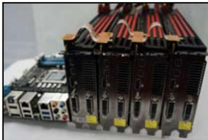
5. 各ビデオカードに補助電源装置を接続します。
