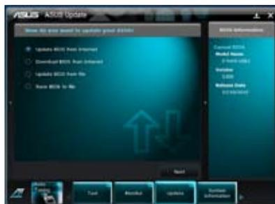
2. BIOSファイルをダウンロードするサーバーを選択し「進む」をクリックします。UEFI BIOSのダウングレード機能を有効にする場合は、チェックボックスにチェックを入れてください。
