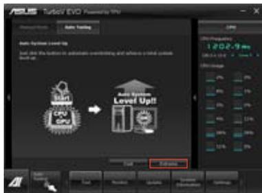
3. TurboVは自動的にCPUとメモリーをオーバークロックし、システムを再起動します。Windows®が起動すると、現在のオーバークロックの結果が表示されます。この結果をキープするには「停止」をクリックします。
