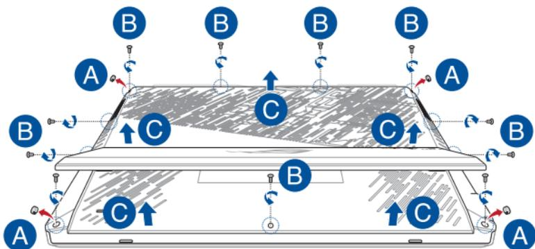
Para volver a acoplar la tapa del compartimento:
